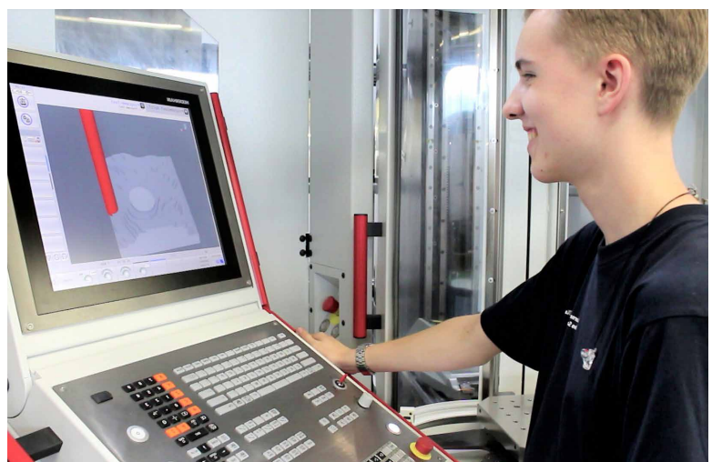
Ivo prüft am Steuerungscomputer den Fortschritt des Fräsprogrammes mittels 3D-Ansicht.
