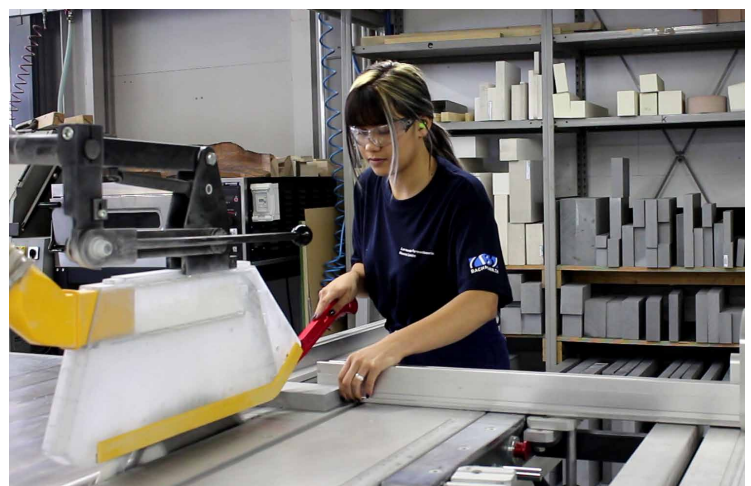
Naomi bereitet die Platte für das Musterwerkzeug vor, das später gefräst wird.
